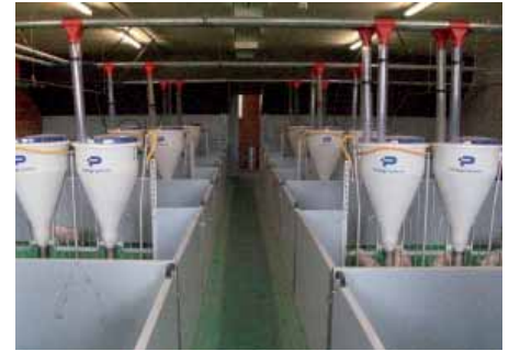
PigsFeeder double: Breifutterautomat für Vormast bis Endmast
