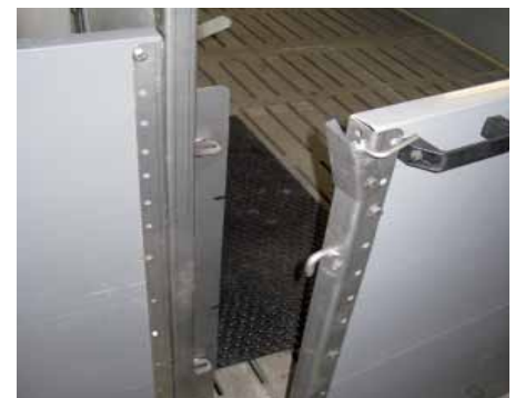
Öffnungsmechanismus mit Daumendruckwinkel
