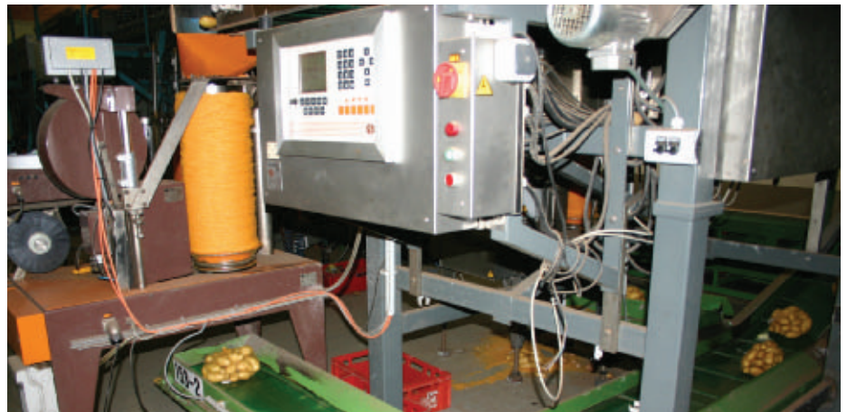
Kartoffeln werden bei Entrup gewaschen, verlesen und in Kleingebinde von einem bis zu fünf Kilo verpackt.
