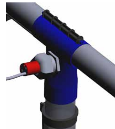
Sensor montiert im PS-Auslauf
