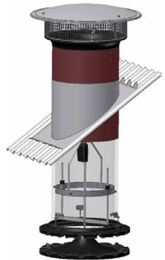
Aufbau eines Zuluftverteilers
