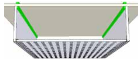
Lüftungsdecke PVC/PS oben: PVC beschichtet, Farbe: weiß mittig: Expandiertes Polystyrol unten: PVC beschichtet, Farbe: weiß Plattenstärke: 25 mm
