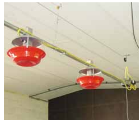
Endkontrollschale mit Antriebseinheit 0,55 kW
